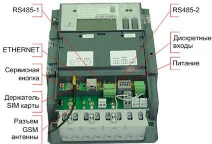
Рисунок 5.4 Вид счетчика «Меркурий 234» с функциями телемеханики с элементами подключения
